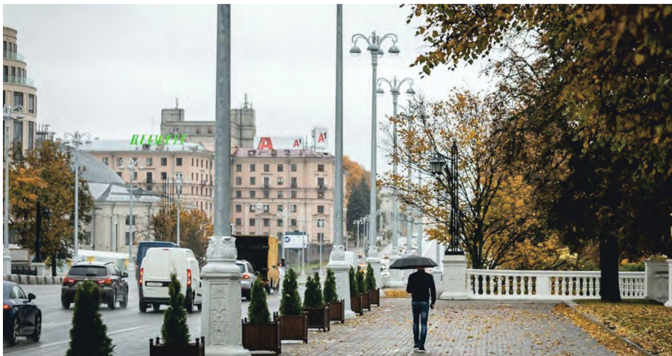
Опоры конусные с кронштейнами, выполненными методом высокохудожественного литья, г. Минск, пр-т Независимости
