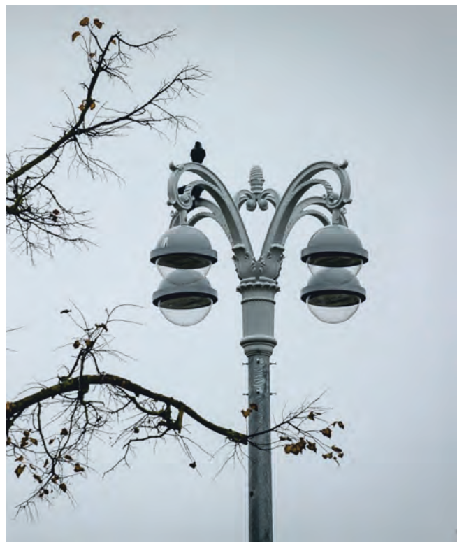
Опоры конусные с кронштейнами, выполненными методом высокохудожественного литья, г. Минск, пр-т Независимости
